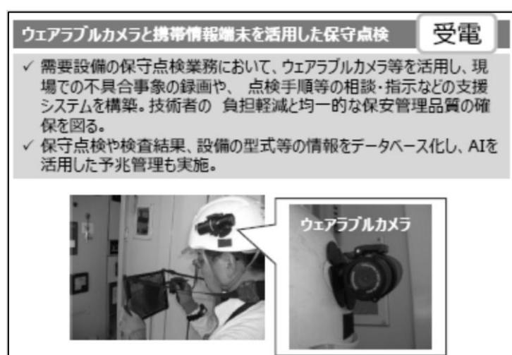
図表 35 ウェアラブルカメラと携帯情報端末を利用した保守点検
